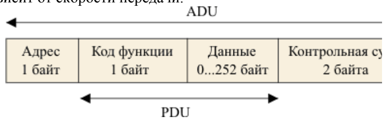
Рис. 2.25. Формат кадра протокола Modbus RTU; PDU - "Protocol Data Unit" - "элемент данных протокола"; ADU - "Application Data Unit" - "элемент данных приложения"
